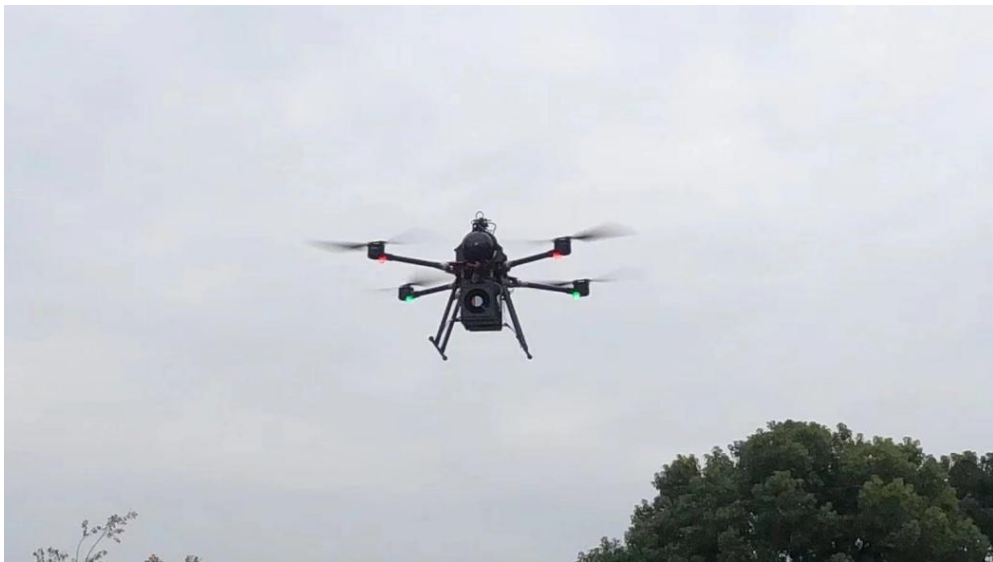
(图：由符文忠主导设计，公司与斗山创新联合研发的25kg级四旋翼无人机试飞)
